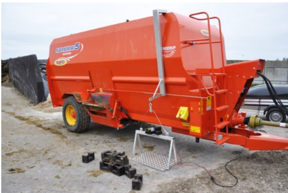
Figur 2 Den ene bøjle og plade monteret og klar til at starte testvejningen.
