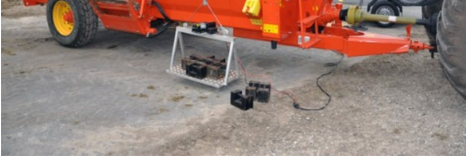
Figur 3 Den ene bøjle og plade, løftet med lodder på under testen.
